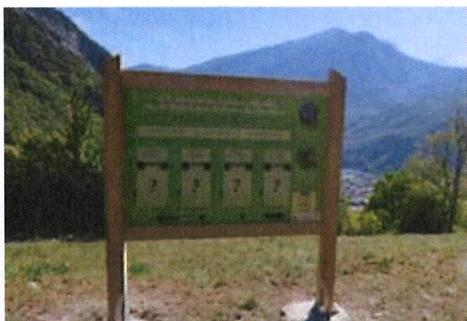
Visuel de 140\*100 en inclusion, décor sur une face, monté sur structure mélèze poncé garanti 10 ans provenant de forêts certifiées, composée de 2 poteaux de hauteur 220 et de section 12\*12 cm et 2 traverses de sections 7.5\*5.5. Liaison au sol par platines spitées. Visserie inox. Fixation du panneau par parecloses démontables.
