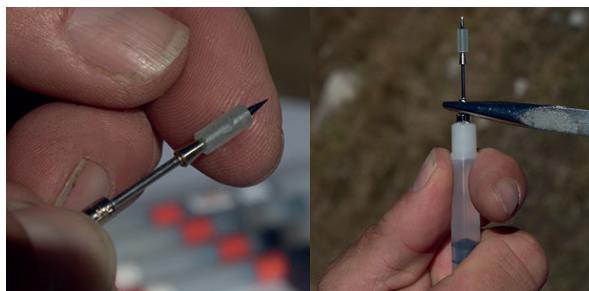
SIGILLARE IL FORO LATERALE DELL'AGO CON IL GOMMINO, PRIMA DI FISSARE L'AGO SULLA SIRINGA.
