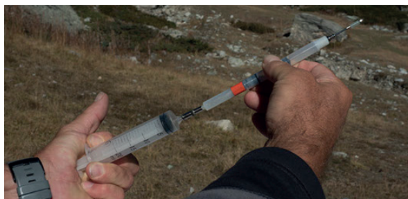
PRESSURIZZARE LA SIRINGA INTRODUCENDO ARIA NELLA CAMERA POSTERIORE
