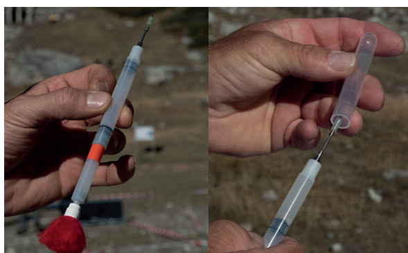
PRESSURIZZARE LA SIRINGA INTRODUCENDO ARIA NELLA CAMERA POSTERIORE
