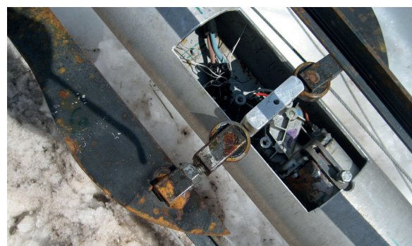
QUANDO LA TRAPPOLA VIENE FATTA SCATTARE, I BRACCI MOBILI E IL DISTANZIATORE PERMETTONO LA CADUTA DEL TELAIO E DELLA RETE AD ESSO COLLEGATA.
