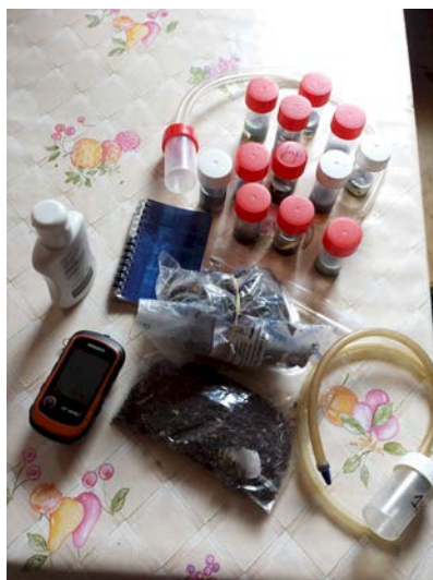
Fig. 8. Matériel de collecte et 1 ers échantillons GPS, aspirateurs à bouche, alcool, carnet, sachets, tubes
